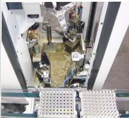
Innenraum einer vollautomatisierten Maschine mit Meßstation, Bürststation Ladeorientierung
